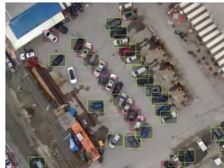
Рис. 5. Розпізнавання автомобілів на аерокосмічному знімку за допомогою нейромережі YOLOv6
