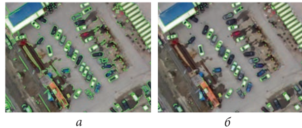
Рис. 4. Розпізнавання автомобілів на аерокосмічному знімку методом Canny : a – порогові значення 80/150; б – порогові значення 200/250
