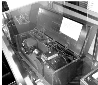
Рис. 2. Серийный электрокардиограф компании *CSIC*
