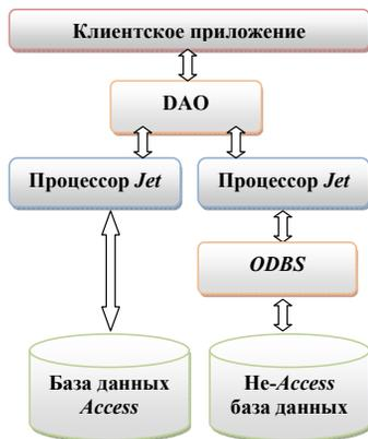
Рис. 3. Использование *DAO* для доступа к БД
