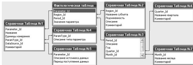
Рис. 3. Пример базы данных со схемой «снежинка»
