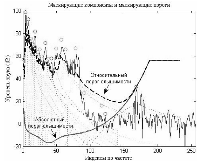
Рис. 3. Пример определения порогов маскирования для одной из психоакустических моделей стандарта MP3 (ПАМ1)
