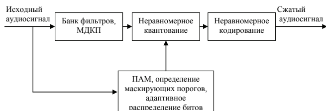
Рис. 1. Обобщенная схема кодеров сжатия аудиосигналов с потерями качества
